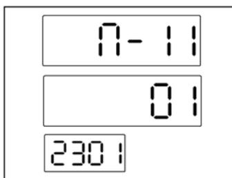
Функция позволяет установить момент аварийного отключения ТРК в случае работы на закрытый кран. Диапазон регулировки от 30 сек. до 180 сек.
