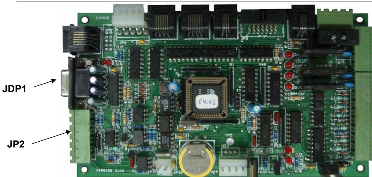
Подключение ГНК EUROPUMP по интерфейсу 2-WIRE.
