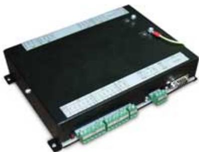
Блок сопряжения ТОПАЗ-133-4-4М (разработчик «Топаз-Электро») предназначен для управления топливораздаточными колонками, оснащенными механическими или электронными отсчетными устройствами с импульсным (неинтерфейсным) управлением.
