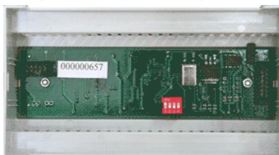
Адрес контроллера "Штрих-ТРК-10М" задается при помощи DIP-переключателя, который расположен на электронной плате.
