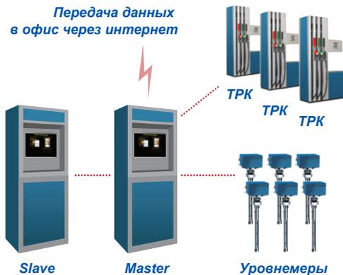
**GasNet Terminal** оборудован сенсорным дисплеем Elotouch, источником бесперебойного питания, устройством контроля зависания модема и компьютера, акустической системой, термоизоляцией и подогревом.
